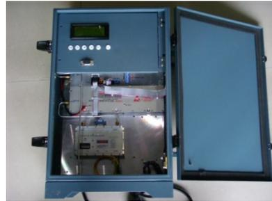
FM Link-104/108 一個近端機(MOU)可連接 4/8 個遠端機(ROU)。對於已有信號光纖的區域，只需要遠端機(ROU)即可。
